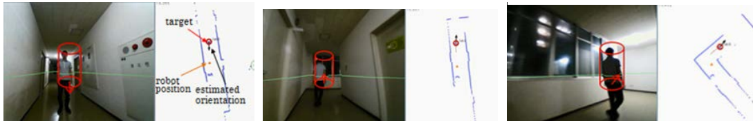
図 3-2-2 人物追従時の上体向き推定結果 (円筒：人物位置、矢印：上体向き)
