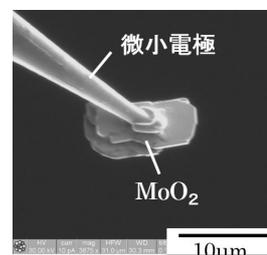
図 2-1-1  $\text{MoO}_2$  単一粒子電極の SIM 像
