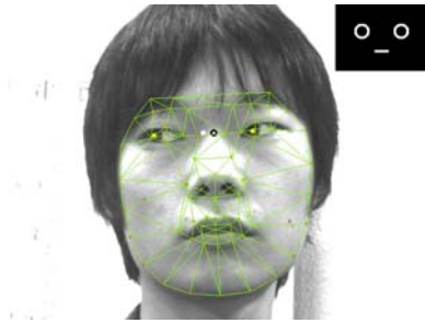
図 1 - 1 - 5 視線方向計測時の画像処理例
