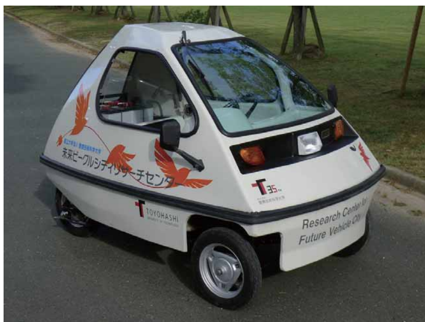
図 1-3-1 本研究室で製作した実験用小型 EV
