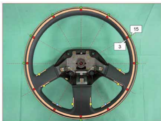
図 4-1-7 ハンドルセンサの概観とセンサ配置
