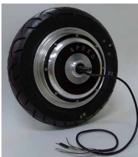
図 1-3-2 インホイールモータ (600 W, 48 V)
