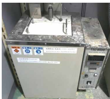
写真8-8-2 溶融塩恒温槽の様子
