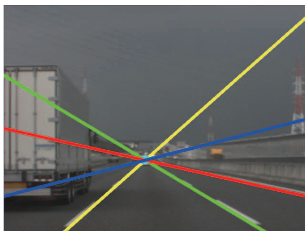
図 6-3-9 車両前方画像中の白線抽出処理の結果
