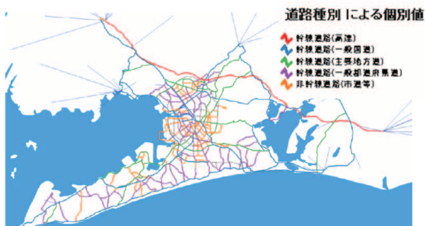
図 2-4-1 将来道路網（破線の区間が計画路線）
