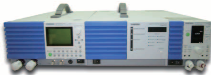
図 1-6-1 二次電池充放電装置
