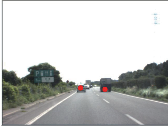
図 6-3-10 車両前方画像中の車両抽出処理の結果
