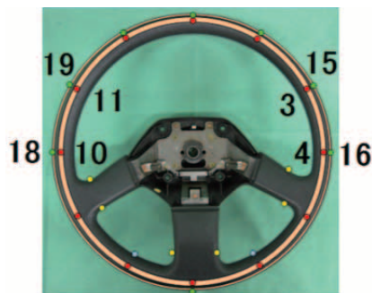
図 6-1-1 ハンドルセンサシステムの外観と内部のセンサ配置
