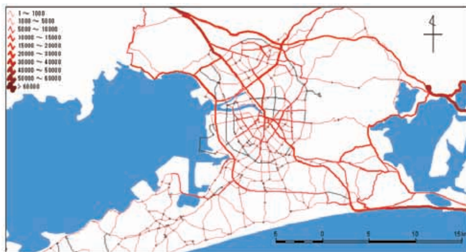
図 2-4-3 時間帯別車種別均衡交通量配分結果の 1 日合計値（乗用車換算台数単位）
