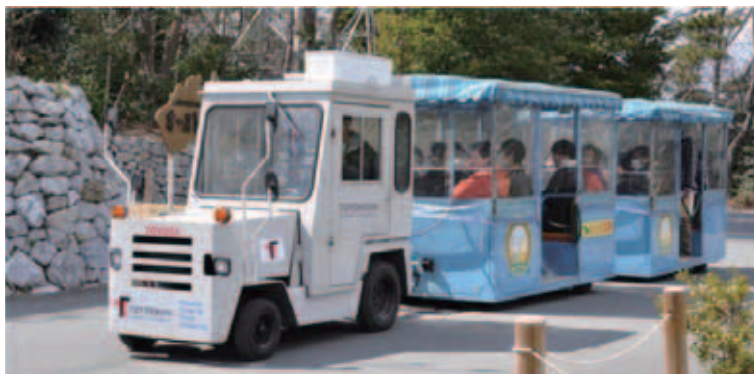
図 1-1-1 EV 化した車両 (牽引車部分) を用いたフィールド試験の様子
