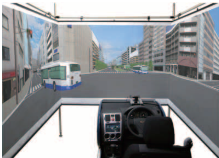
図 6-2-1 本研究で構築したドライビングシミュレータ装置
