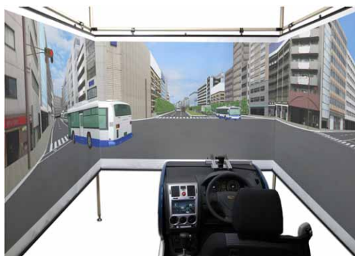
図 6-2-6 本研究で構築した ドライビングシミュレータ装置
