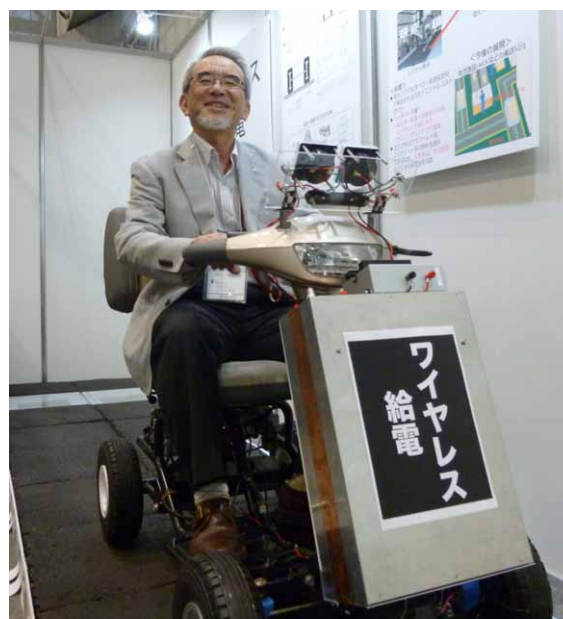
図 9-4-2 電化フロア電動カートシステムによるバッテリーレス電動カートの有人走行実演展示
