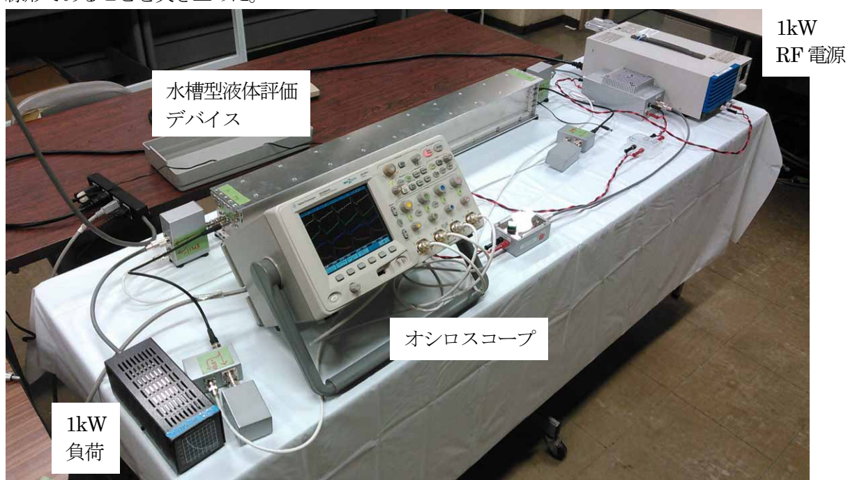
図 9-4-5 大電力誘電率測定システム
