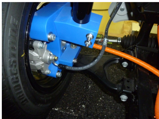
図 1-2-1 試作したタイヤ集電機構
