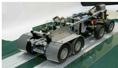
図. 道路からの非接触電力送電により走行するバッテリーレス車両の実演デモ
