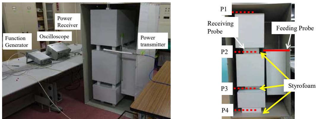
図 1-4-1 実験モデル（左）と送受電器の位置（右）
