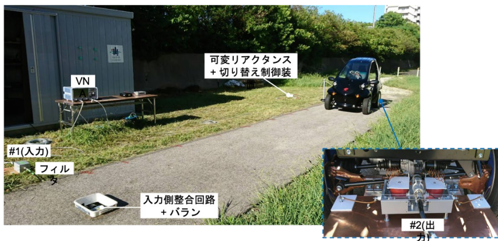
図 1-1-2 FERMAT 方式搭載走行中ワイヤレス給電システムの実証実験
