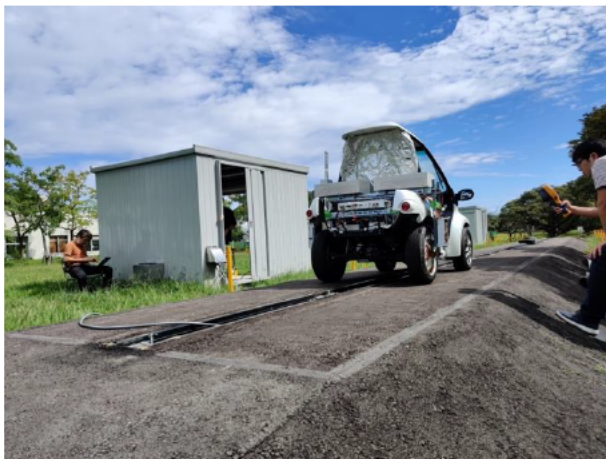
図 1-1-1 新しく敷設した高効率電化道路と実験用車体を用いた実験の様子
