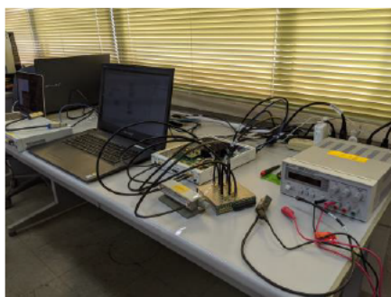
図 5-3-2 自己干渉除去の評価システムの概観
