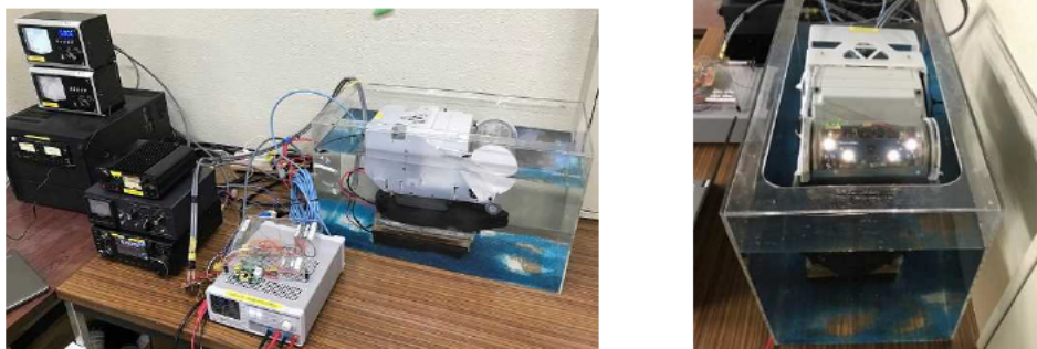
図3：給電ステーションに着底した水中ドローンへの給電実験
