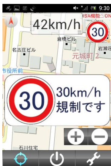
図 1 : 研究チームが開発し、2014 年から 2015 年に ISA フィールド 実験に使用したモバイルアプリケーション
