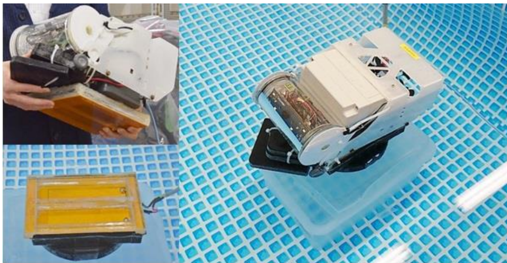
図1-2-1 水中ドローンへのワイヤレス給電
