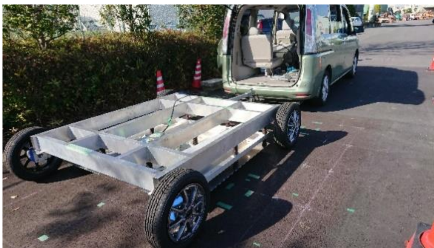
図 1-2-1 走行中連続ワイヤレス電力伝送実験風景
