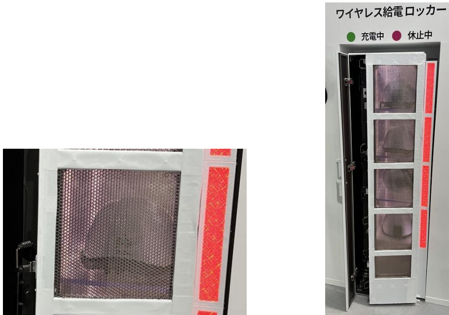
図1-4-1 ワイヤレス給電ロッカー (モニタリングシステムが搭載されたヘルメット (左), 色々な向きに置いても給電可能 (右))
