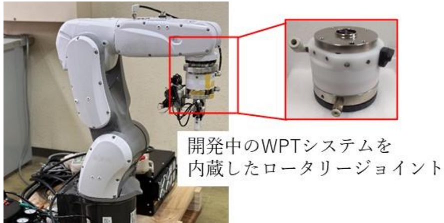
図1-4-1 磁界方式によるWPTシステムを搭載したロボットアーム
